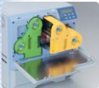
O cartucho de tinta facilita a instalação das fitas (verde para a de re-transferência e amarela para a fita YMCK )
